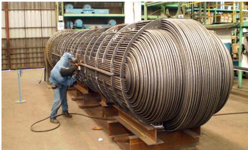
Figura 2.9. Intercambiador de calor, fabricación especial. (2021). <http://www.tycsa.com.ar/tycsa/planta-industrial.html>
