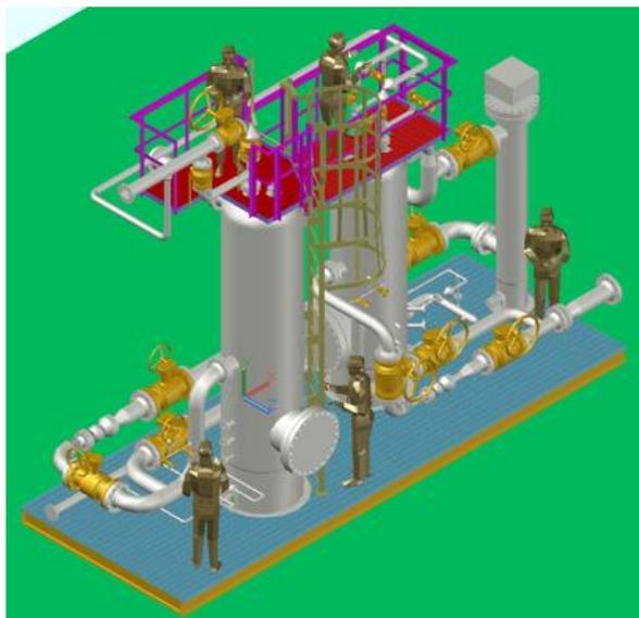
Figura 2.2. Equipo paquete de acondicionamiento de gas. Fuente: Cortesía, Vimexca Ingeniería.
